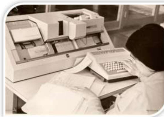
Una din mașinile Juky de perforare/verificare cartele
